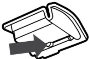
Presione el gancho flexible para abrir el sensor
